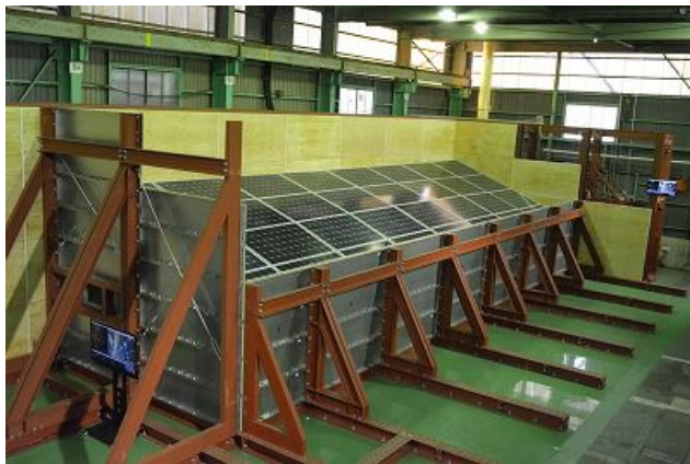
(写真: 左: 水平型動風圧試験装置 ・ 右: 加圧ファン) 奥地建産(株) 本社工場(大阪府松原市)に新設した動風圧試験装置
