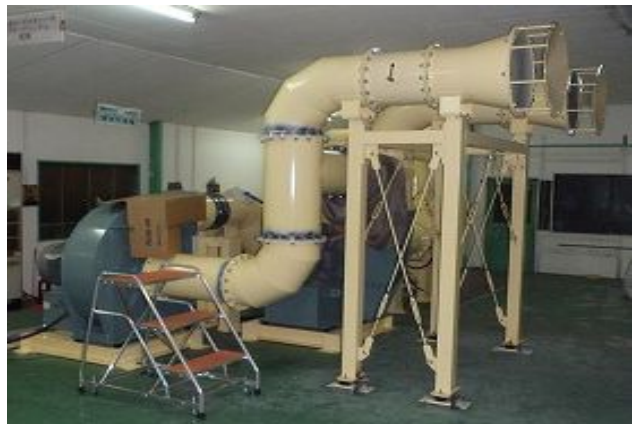
(写真: 左: 水平型動風圧試験装置 ・ 右: 加圧ファン) 奥地建産(株) 本社工場(大阪府松原市)に新設した動風圧試験装置
