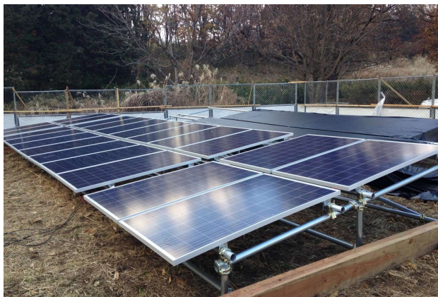
写真・左：水没実験に用いた太陽光発電設備
